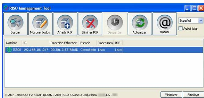
La IS300 arranca de nuevo automáticamente y la configuración establecida en el paso 3 se hace efectiva. A continuación, instale el controlador de la impresora. Vea “Instalación de la impresora” p. 32
