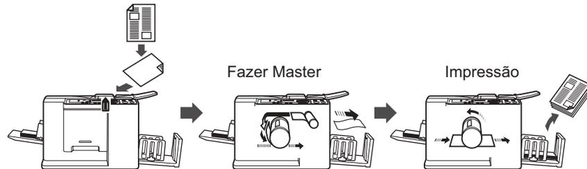
Um original colocado no ADF é digitalizado pelo scanner e o master gerado é enrolado em torno do Tambor de Impressão.
