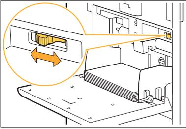
Normalmente, coloque a alavanca na posição “✖ (NORMAL)”. Se a alimentação de papel for problemática, coloque na posição “✖ (CARD)”. Para mais informações, consulte “Carregar papel no tabuleiro standard” no “Manual do utilizador”.
