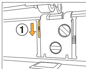
1 Baixe o manípulo de bloqueio do extrator (1) para desbloquear a unidade extratora.
