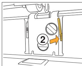
2 Pressione a alavanca de liberação do extrator (2) e remova a unidade extratora.
